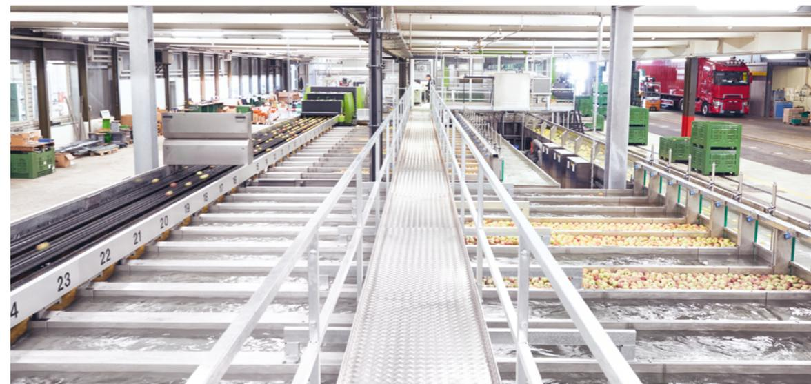
Die neue Apfelsortieranlage in voller Grösse – mit einer Verarbeitungsleistung von über 16 Tonnen pro Stunde.
